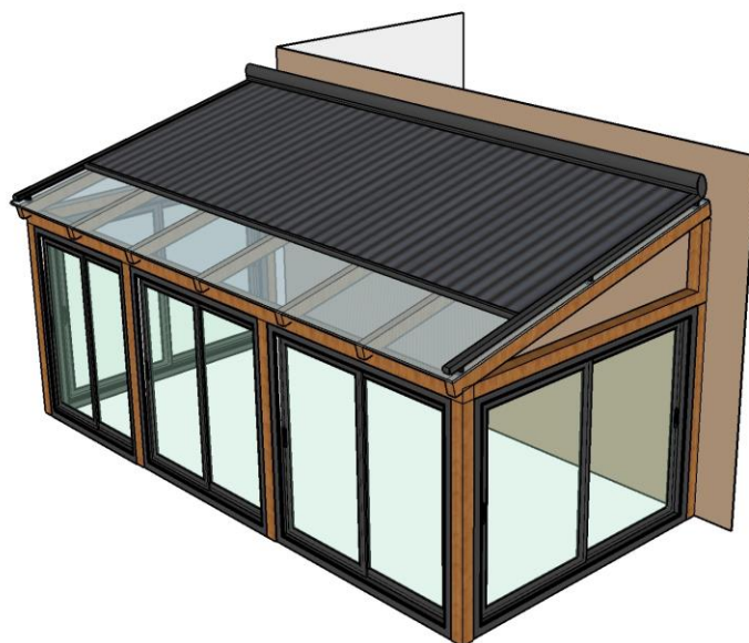
D, Výměna polykarbonátu za čiré sklo
